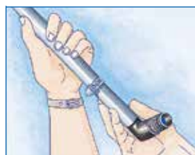
Modo de montar el tubo de polietileno con accesorio de inserción: 1. Coloque la abrazadera sobre el tubo y luego coloque el accesorio dentado.
