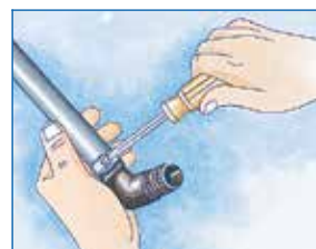
Tubo de polietileno: 2. Ajuste la abrazadera alrededor del tubo y del accesorio.
