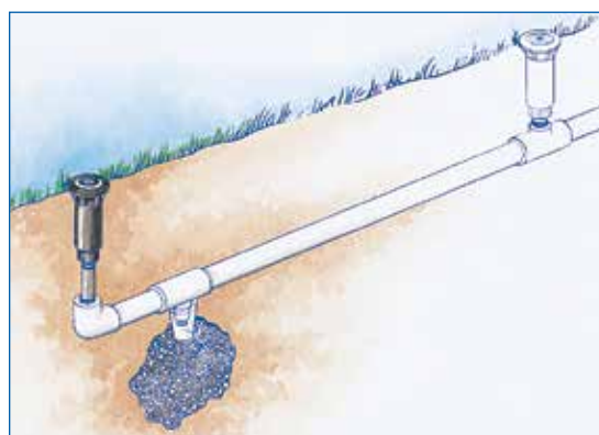
Instalación de la válvula de drenaje automática para las zonas con temperaturas bajo cero: Coloque las válvulas de drenaje en los lugares más bajos en cada una de las zonas.
