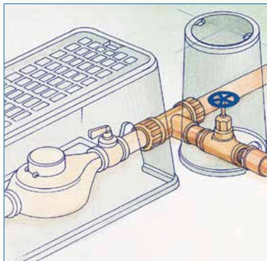
Punto de conexión en climas sin temperaturas bajo cero: Utilice una T de compresión de cobre para conectar su sistema de riego al suministro de agua..
