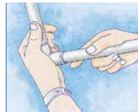
PVC: 2. Introduzca la tubería en el accesorio y limpie el sobrante.
