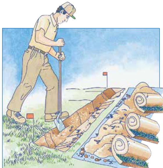
Primero, tienda las lonas y quite el césped, luego cave zanjas de 25 cm a 30 cm de profundidad para la línea principal. Haga zanjas de 15 cm a 20 cm para las líneas laterales.
