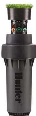
I-80-04-SS-TC עם כיסוי דשא I-80-04-SS-ON-TC עם כיסוי דשא גובה כולל: 29 ס"מ גובה גיחה: 9.5 ס"מ קוטר חשוף: 8.9 ס"מ קוטר כניסה: 1½" (40 מ"מ)
